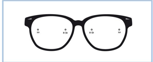
Figura 2. El grabado de la adición siempre se encuentra en la zona temporal de la lente. (Vista de la lente de frente)
